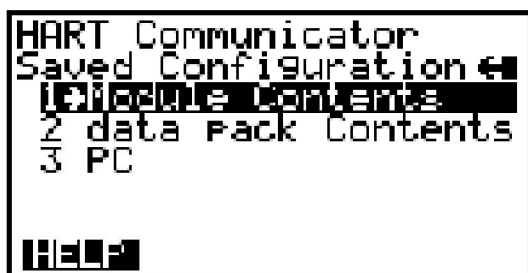
شکل ۱-۱۷. منوی Saved Configuration
