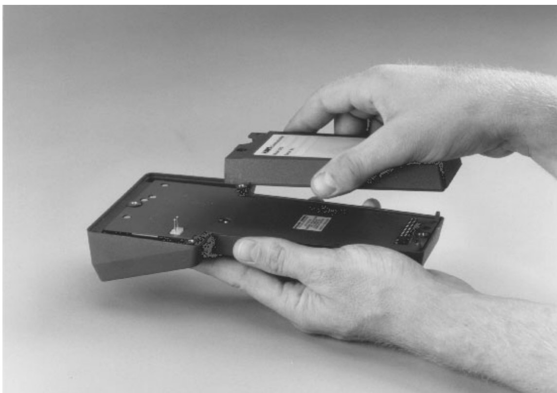
شکل ۳-۲. تعویض ماژول حافظه
